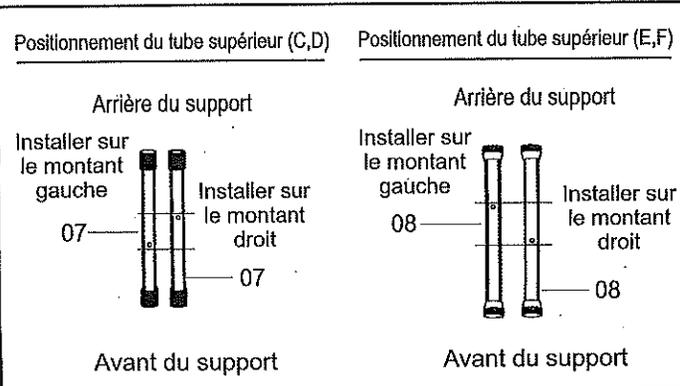
C. Placer le cadre en X 06 en orientant le bouton 04 vers vous. Passer la vis 05 dans le tube rond 07, puis la fixer dans le bras supérieur droit du cadre en X 06 à l'aide de la clé 09.
